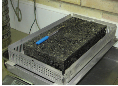
(a) Deney öncesinde bitümlü karışım numunesi
