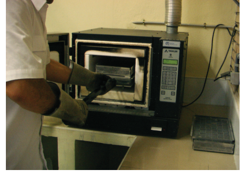
(b) Numunenin fırına verilmesi
