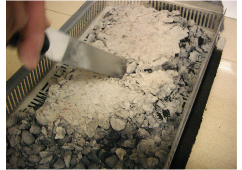
(f) Deney sonrasında numuneler bağlayıcı madde tarafından sağlanan kohezyonunu kaybedip üzeri kolayca kırılabilen hale gelmektedir.
