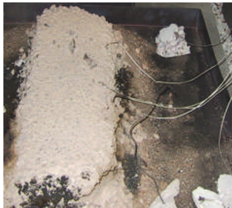
Şekil 9: Yanma deneyinden sonra bitümlü karışım (Cergy – Pontoise Üniversitesi)
