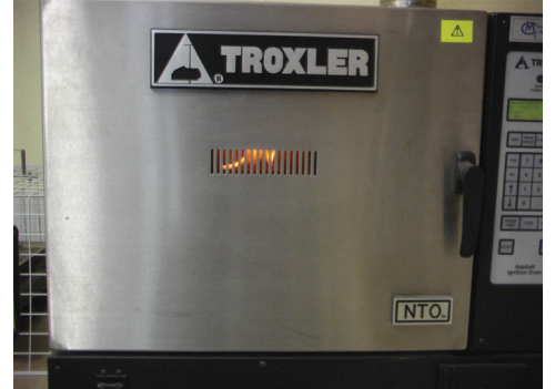
(d) Bitümlü karışımın deney esnasında kızdırılması
