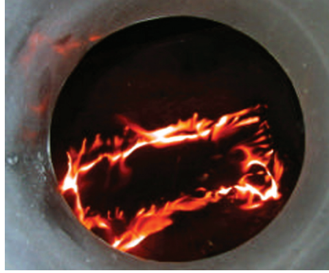
Şekil 8: Yanma esnasında bitümlü karışım (Cergy – Pontoise Üniversitesi)
